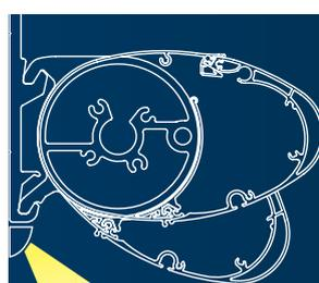
Monté sur le mur et sous le coffre, le LED strip étanche (en option) offre un éclairage parfait
