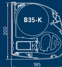
Différentes versions du B-35, du système ouvert (type A) au coffre entièrement fermé (type K). Le B-35 Prestige est uniquement disponible avec coffre fermé (type K) ou semi-fermé (type I). Le profil gouttière type G est disponible en option pour toutes les versions.
