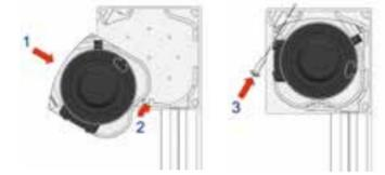
Dans les screens standards et ZIP, il est facile de retirer le tube d'enroulement sans démonter le screen, ce qui permet un montage simple.
